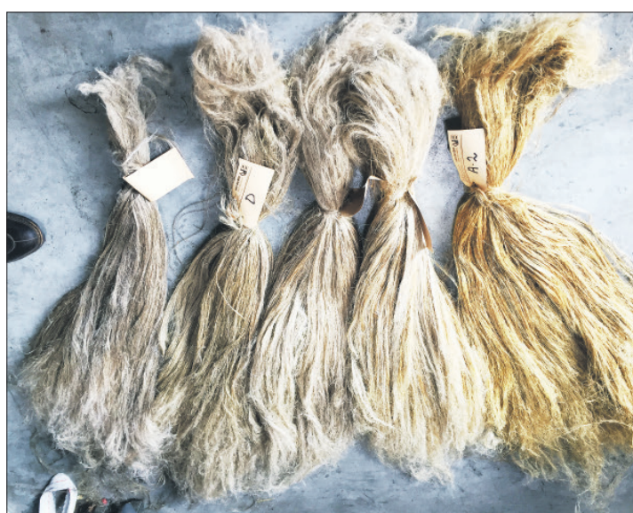
Schwingflachs in unterschiedlichen Qualitäten: links überröstet und rechts unterröstet. So werden die Fasern weiterverarbeitet.
